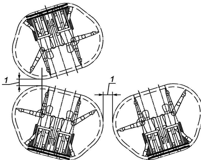
1 - дополнительный зазор 0,5 м
