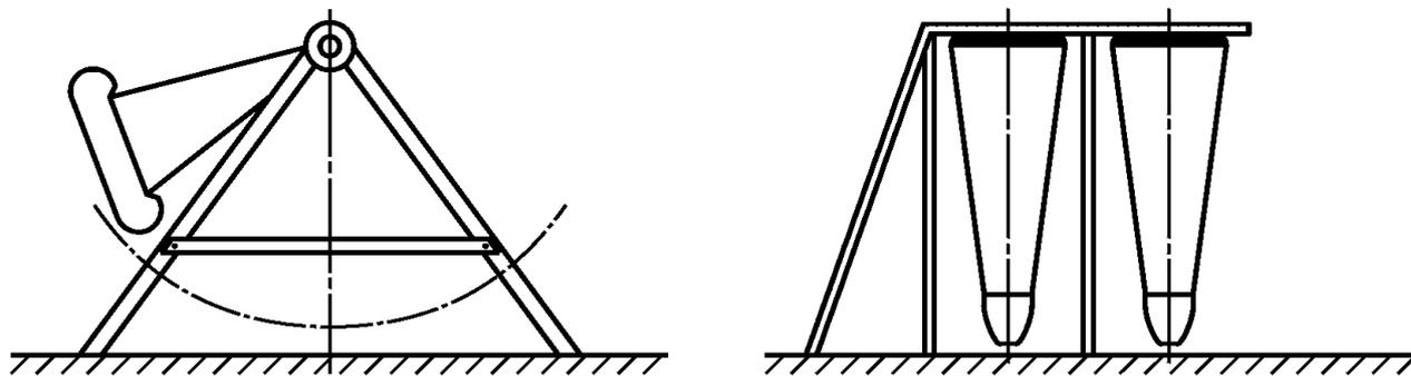
в) Вращение пассажирского модуля вокруг горизонтальной оси
