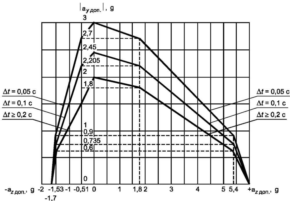
Рисунок Б.4 - Допустимые ускорения  $a_y$  и  $a_z$
