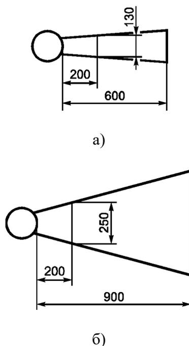
Рисунок 2 - Размеры спиральных и винтовых лестниц
