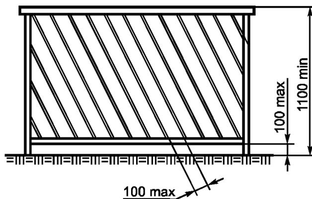
а) Ограждение с наклонным расположением внутренних элементов
